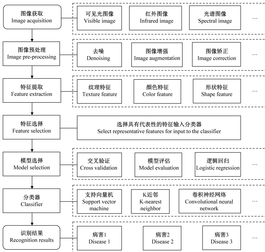
图 2 基于传统机器学习的作物病害识别主要流程
