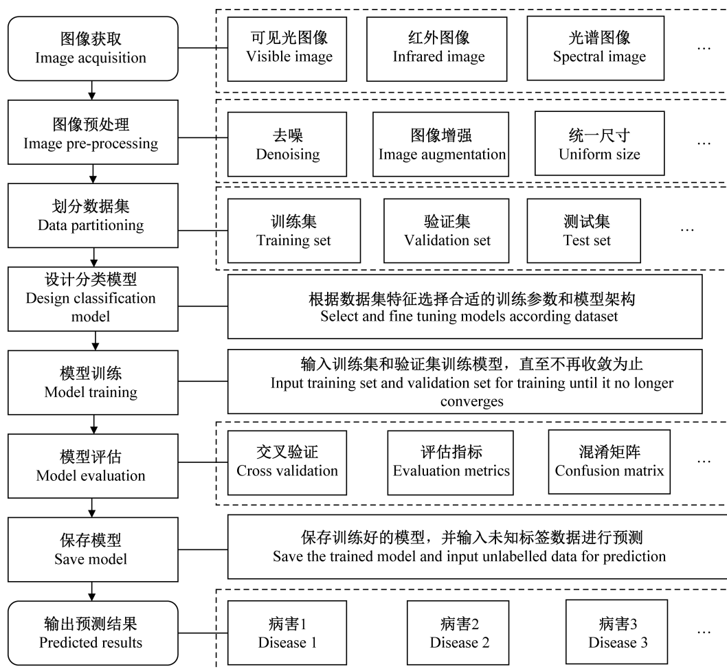
图3 基于深度学习的作物病害识别主要流程
